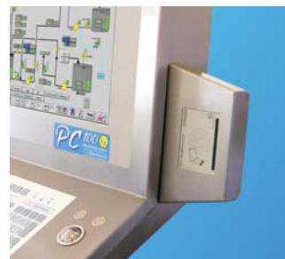
Bild 6: Berührungsloses RFID-System zur Bedienererkennung an HMI-Systemen.
